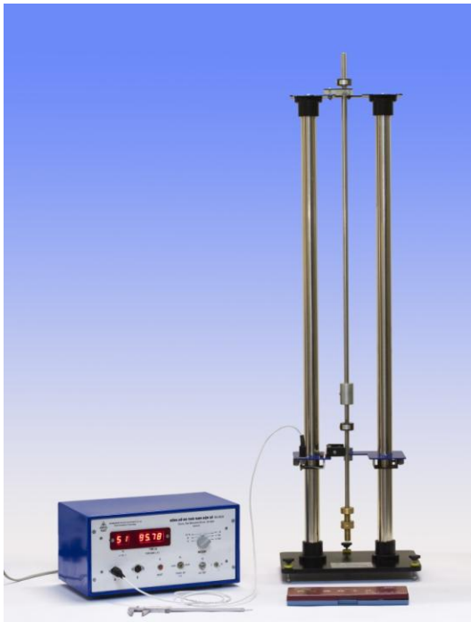
Hình 1: Bộ thí nghiệm khảo sát dao động của con lắc vật lý- Xác định gia tốc trọng trường.
